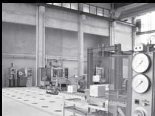
baulab.3, Laborhalle mit Aufspannfeld
